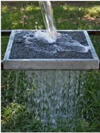
Figura 20 – Piso de concreto permeável
