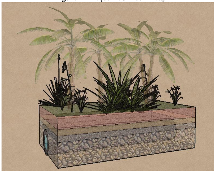
Figura 1 – Esquema 3D do TEvap
